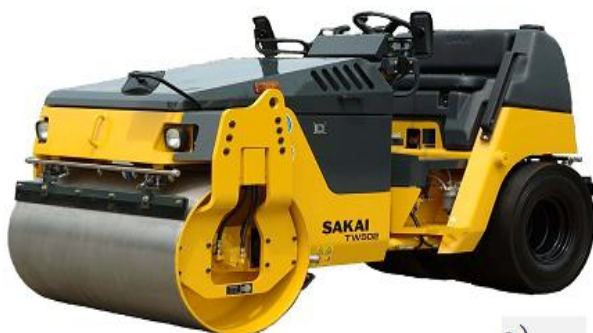
3 –сурет - Фирмалардың «SAKAI» TW502 (а) және «РАСКАТ» ДУ 99 (б) аралас катоктары
