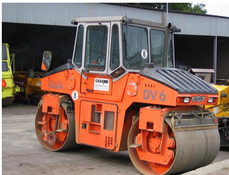
1 – сурет - «Hamm-Wirtgen Group» фирмасының DV-6 көлденең дірілімен вибрациялық каток
