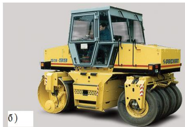
3 –сурет - Фирмалардың «SAKAI» TW502 (а) және «РАСКАТ» ДУ 99 (б) аралас катоктары
