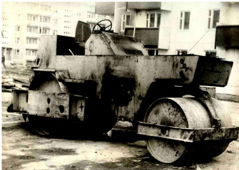
6 - сурет - Вакуумдық - балласт құрылғысыз ДУ-47А жол айдынының жалпы көрінісі
