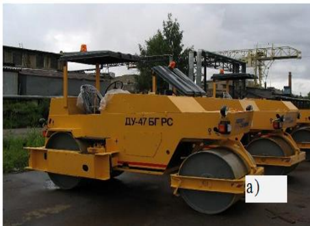
5-сурет – Фирмалардың «Раскат» (а) ДУ 47БГ РС статикалық жол катогы және «НАММ»(б) жол катогы
