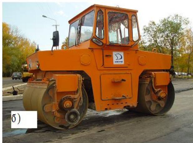
5-сурет – Фирмалардың «Раскат» (а) ДУ 47БГ РС статикалық жол катогы және «НАММ»(б) жол катогы
